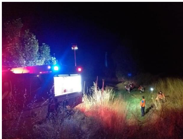
Ilustración 15: Camioneta de Emergencia prestando apoyo de iluminación mediante mástil telescópico y trípode portátil
