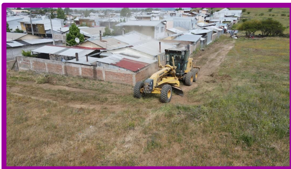
Ilustración 24: Motoniveladora municipal realizando cortafuegos en la interfaz sur de la comuna
